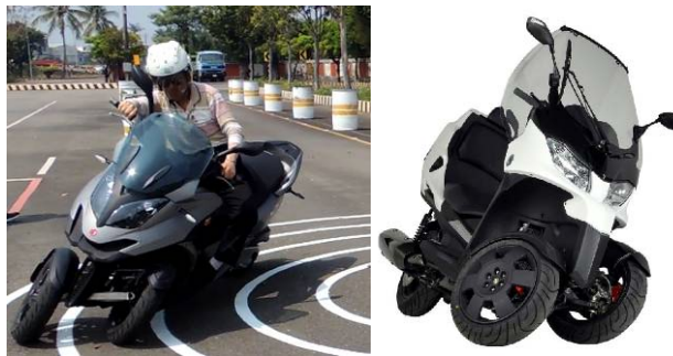
圖二 側傾式三輪機車圖例
