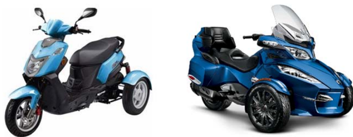
圖一 一般型式三輪機車圖例(左為前一後二型式，右為前二後一型式)
