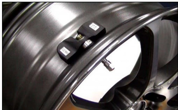
圖十三、胎內式偵測器本體安裝示意圖
