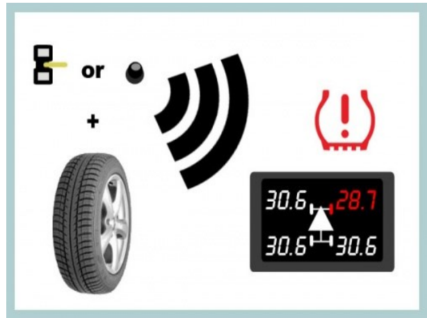
圖六、TPMS 運作原理示意圖
