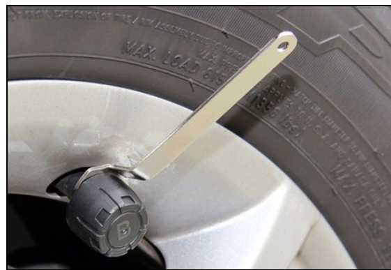
圖十一、胎外式偵測器本體安裝示意圖
