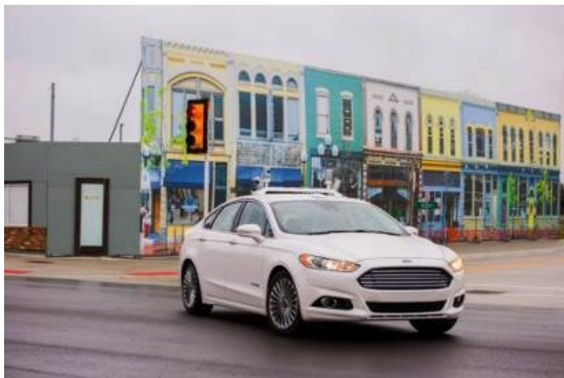
圖二、Fusion 自動駕駛原型車於密西根大學 Mcity 進行測試 圖片來源:
