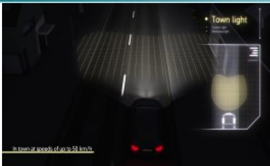
圖五、城鎮型態有較廣的光型分佈
