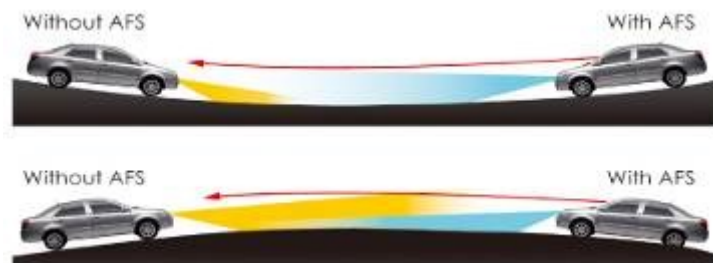
圖三、當路面坡度改變時，裝設 AFS(右側示意圖)及無裝設 AFS(左側示意圖)頭燈光束照射角度之差異。
