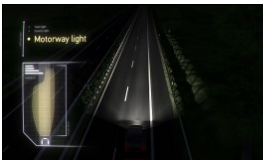
圖七、高速道路型態有較遠的光型分佈
