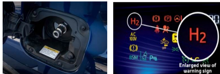
圖二、Toyota Mirai 燃料注入口及警告訊號 (資料來源：Toyota 官方網站)
