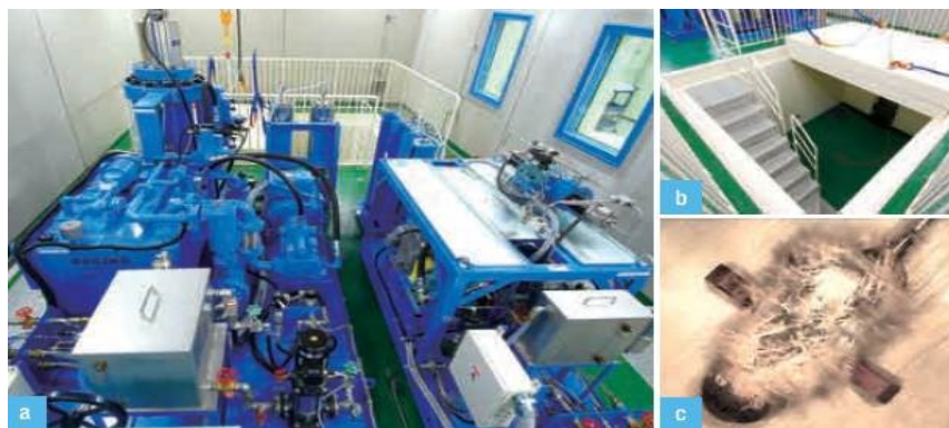
圖五、爆裂試驗相關設備(圖片來源：日本九州氫能研究技術中心)
