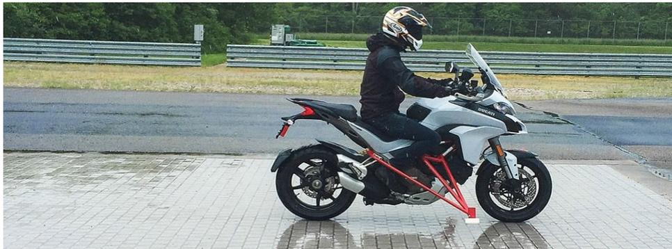
圖四、機車(L類車輛)防鎖死煞車系統(ABS)之檢測示意圖
