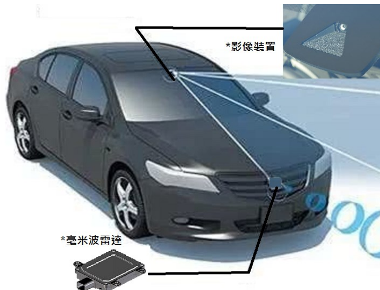
圖二、適應性巡航控制系統之組成概述
