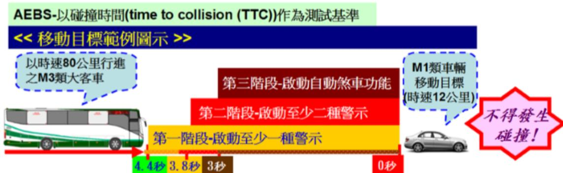
圖三、移動目標測試範例示意圖
