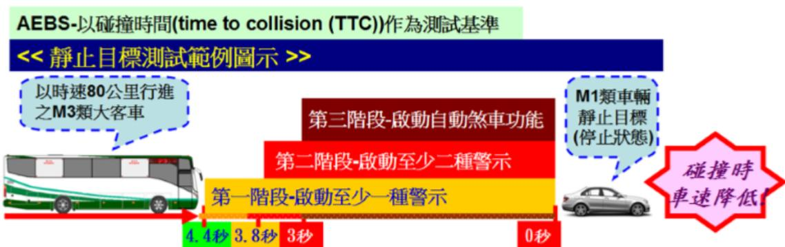
圖二、靜止目標測試範例示意圖
