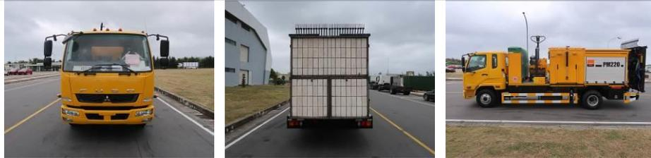
圖 3.配備電氣控制箱、路面加熱板、混合料加熱系統之路面修補車
