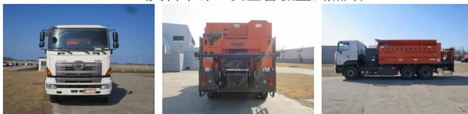
圖 2. 配備容料槽、卸料系統、水柏油系統之路面修補車
