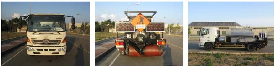
圖 1. 配備壓路滾輪、瀝青儲存器之路面修補車
