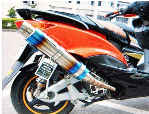
圖3.改裝之排氣管(出口角度已傾斜高於水平線)
