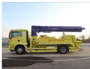
圖 10. 混凝土幫浦車
