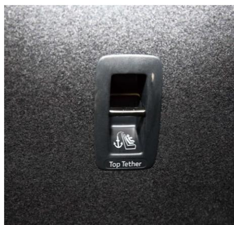
圖八、上固定帶固定器(Top Tether)
