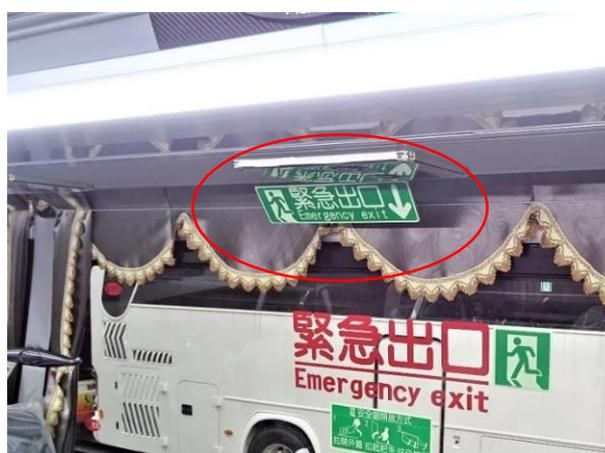
圖十一、額外加裝一安全裝置操作標識示意圖
