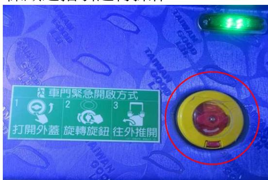
圖十二、緊急控制裝置示意圖
