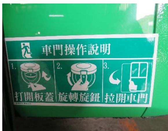
圖十、安全裝置操作標識示意圖
